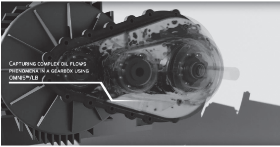
그림 3 OMNISTM/LB를 사용한 기어박스 오일처닝 해석 사례
