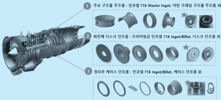
그림 10 터보팬 인코넬 718 주단조품 개발 소재 부품
