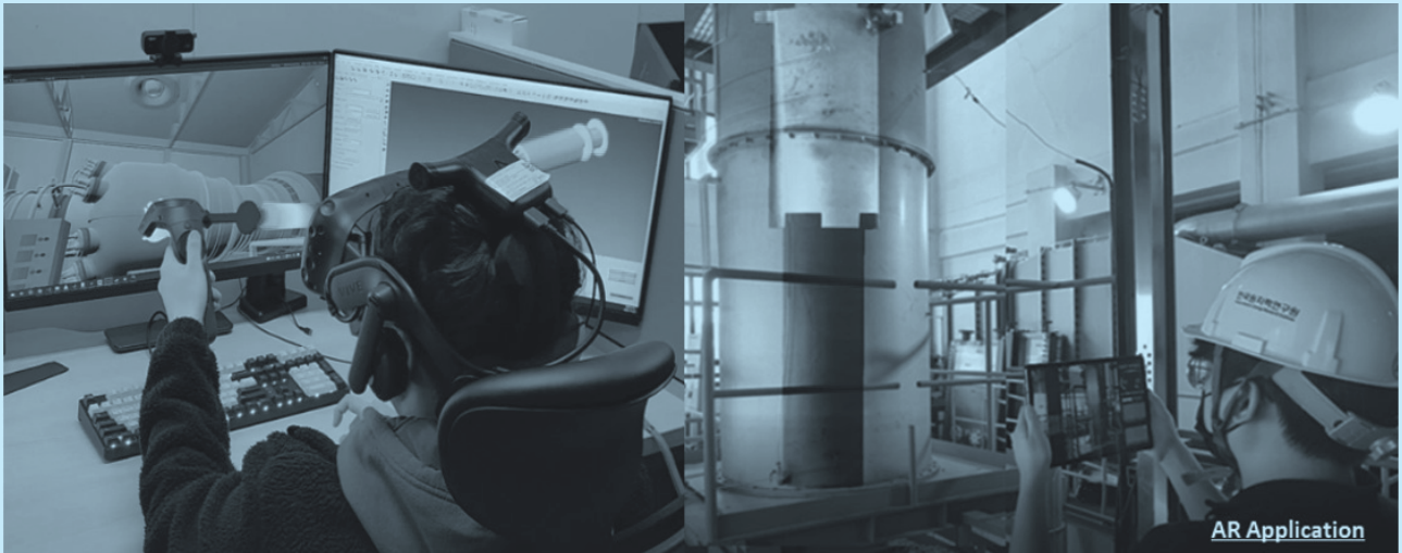
그림 5 가상 센싱 기술을 적용한 원자로 냉각재 펌프 축진동 감시(좌) 및 증기 발생기 습분 분리기 유동 유발 진동(우) 디지털 트윈 개념(한국원자력연구원, 경희대학교)
