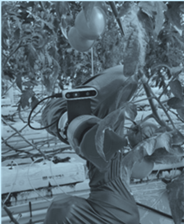
그림 8 한국기계연구원에서 개발한 소프트 그리퍼 기반의 작물 수확 로봇
