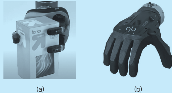
그림 2 와이어 기반 유연 관절형 그리퍼의 종류 : (a) ReFlex 로봇틱 그리퍼(RightHand Robotics사)(출처: https://www.righthandrobotics.com , https://youtu.be/Jwk68AGCHC ); (b) qb SoftHand(qb robotics사)(출처: https://qbrobotics.com/ )
