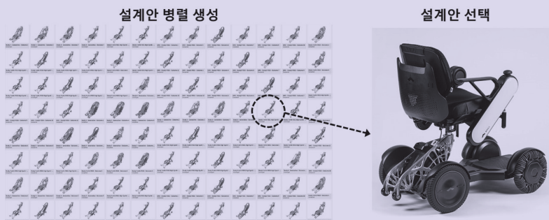
그림 1 제너레이티브 디자인 예시: 휠체어의 경량화 프레임 설계를 위해 제너레이티브 디자인으로 다량의 설계안을 병렬 생성한 후 선택하여 적용함(www.autodesk.com).
